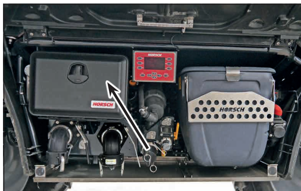
Transpordimahuti masina vasakpoolsel küljel
