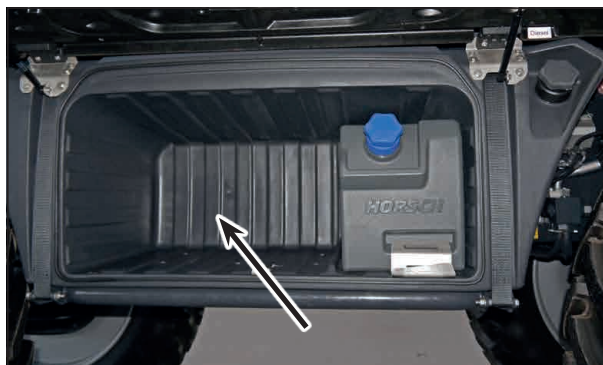
Transpordimahuti masina parempoolsel küljel
