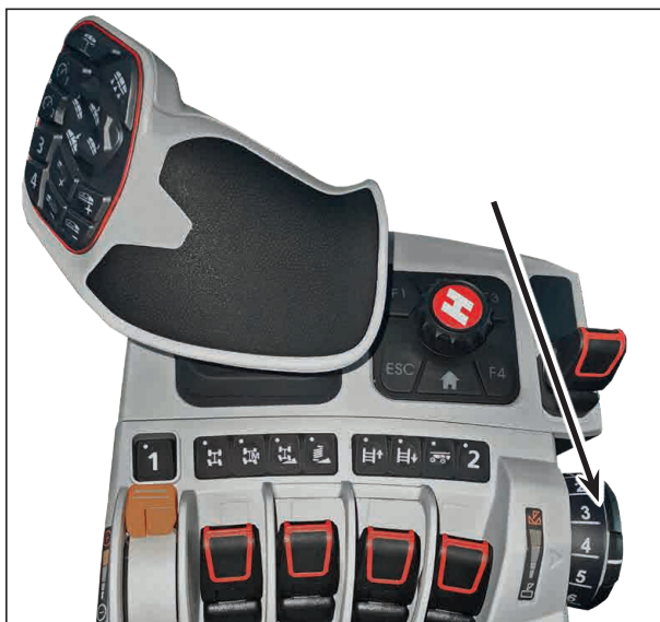
kallakul triivi manuaalne korrigeerimine
