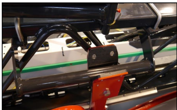
Poomid asetatud transpordiasendisse
