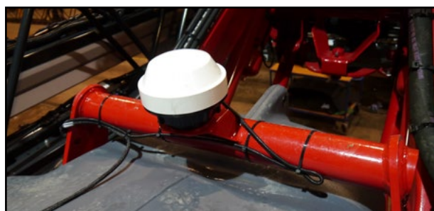
GPS-vastuvõtja on monteeritud traaversi kan-deplekile
