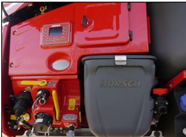
Väline juhtterminal, täiteühendused ja siseloputuslüüs
