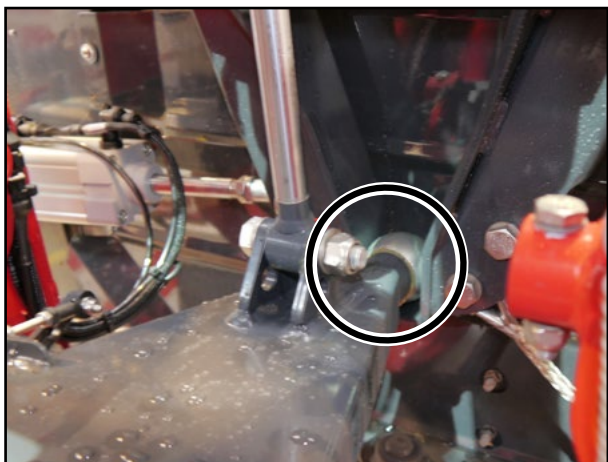
Kalde kompensaaator/pendellukk lukustatud
