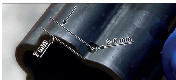
Möödud puuraukude jaoks tihendusrõngaste kinnitamiseks
