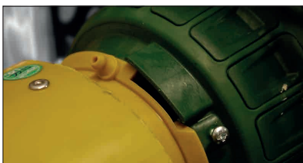
Välikaitsetoru asend - fikseerumata
