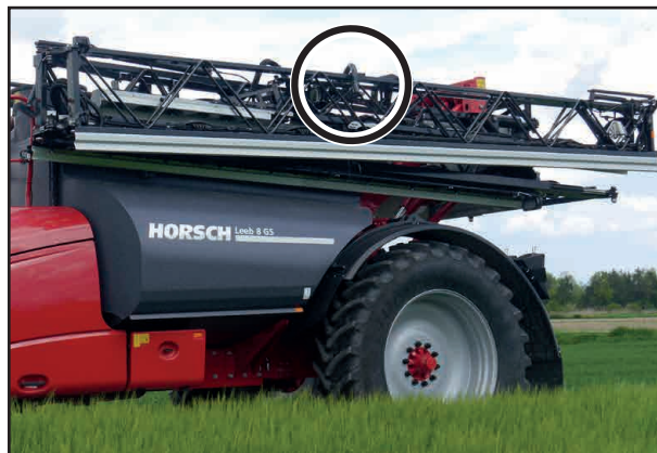
Paketiirivistus on kokku klapitud poomi korral suletud
